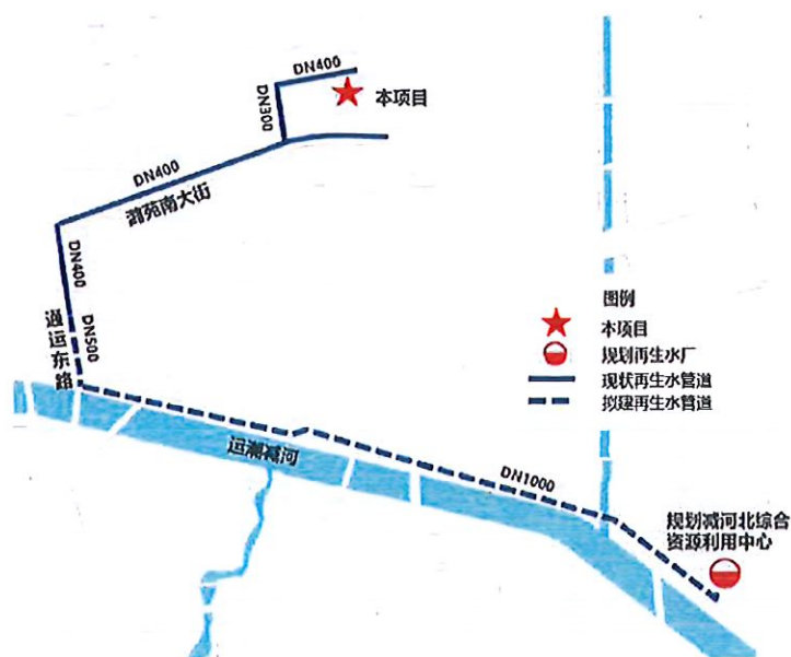
图3 本项目外部再生水干线系统示意图
